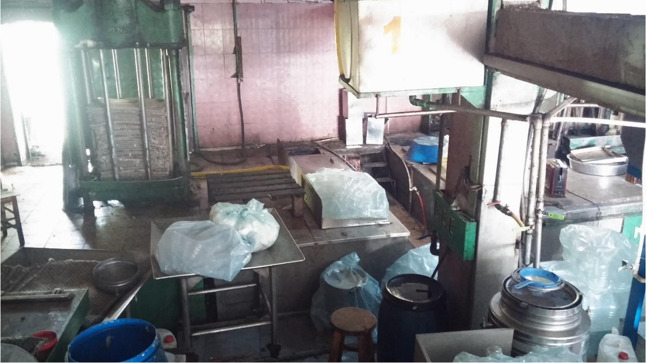
Şekil 11.4. Taş kırma ve hidrolik pressleme yöntemi ile eski sistem çalışan bir yağhane
